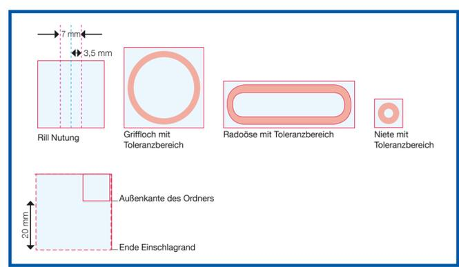
Hilfslinien und Toleranzbereiche dienen lediglich der eindeutigen Darstellung bestimmter Elemente – diese Linien werden nicht mitgedruckt.
